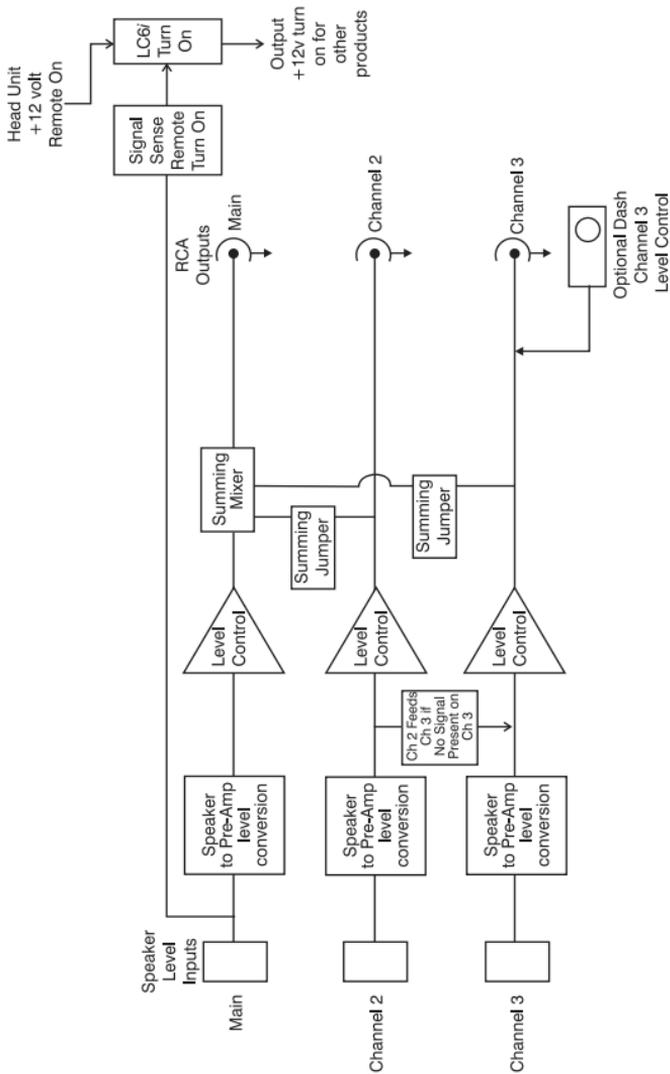
**Figure 4:** LC6i Block Diagram
